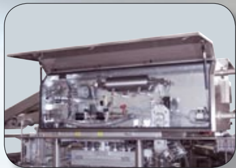
Circuito vuoto e gas. Vac and Gas delivery system. Intérieur du carter, côté moteurs bobines et circuit de vide. Vakuum- und Begasungssystem. Circuito vacío y gas.
