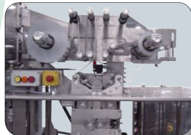
Cambio automatico bobina. Automatic film reel splicing system. Changement automatique de bobine. Automatischer Folienrollenwechsel. Cambio automático bobina.
