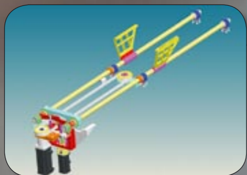
Azionamento spingitori. Pusher arm operating system. Groupe mécanique actionneur des bras de transfert. Greifarmtrieb. Accionamiento empujador.
