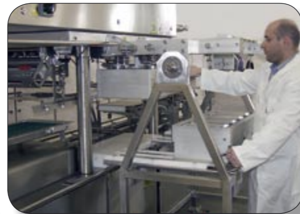
Cambio formato. Change over of sealing tool. Changement de format. Leichter Formatwechsel. Cambio formato.
