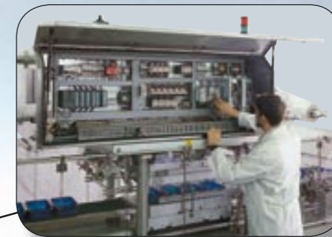
Quadro elettrico. Electrical panel. Armoire électrique. Schaltschrank. Cuadro eléctrico.
