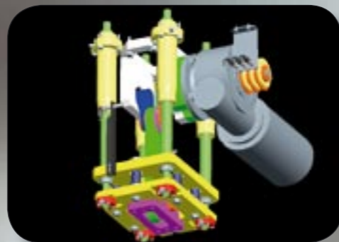
Azionamento stampo chiusura. Mechanical cam operating system - sealing tool closing. Groupe mécanique actionneur de l'outil d'operculage. Antrieb Verschlusswerkzeug. Accionamiento molde de cerrado.
