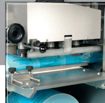
Grupo de soldadura longitudinal Longitudinal sealing group Groupe de soudure longitudinale
